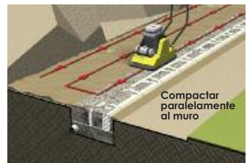
Compactar la grava de muro y los suelos de relleno.
